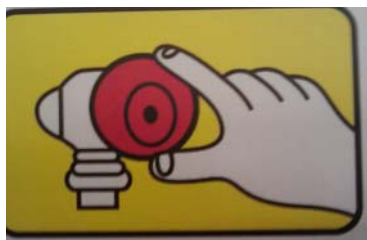
拉開箱門 Open the fire box door
